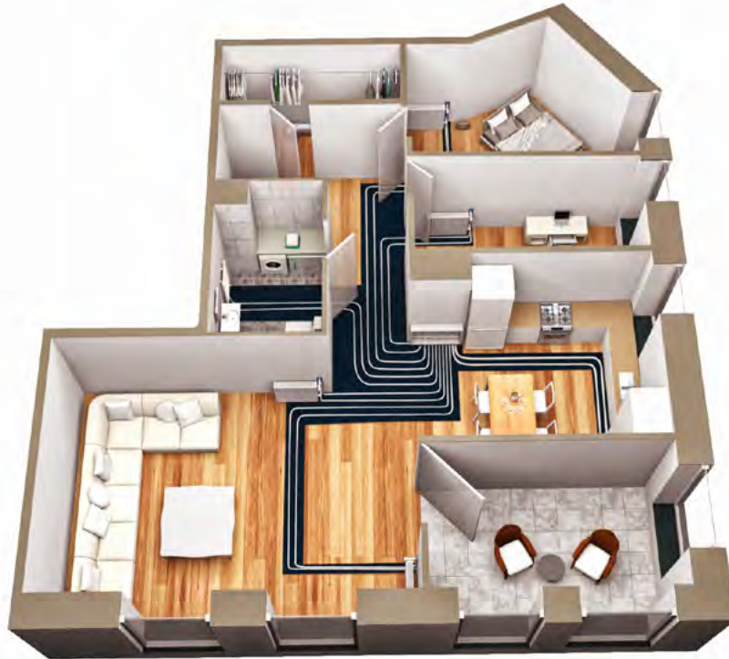
شکل ۱۶ نمونه ای از نقشه یک سیستم کلکتوری
