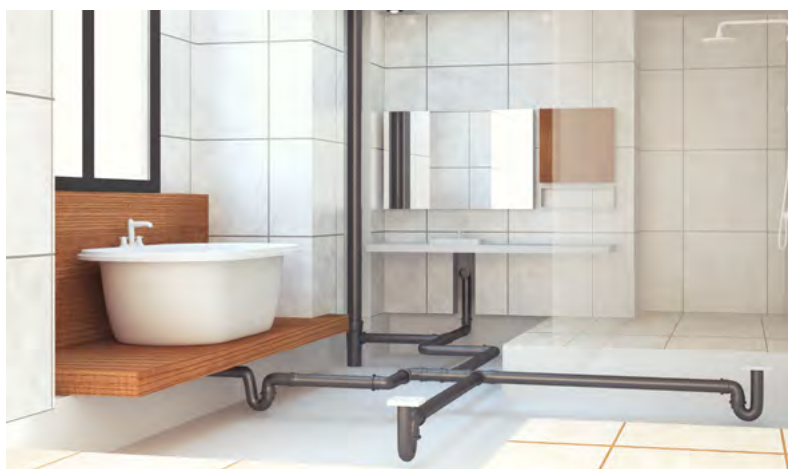
شکل ۲ نمای اجرای پلی تک در حمام
