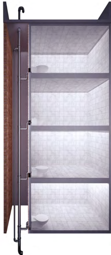
شکل ۸ سیستم فاضلاب بدون هواکش مستقل
